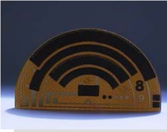
Prüfteil mit konzentrischen Widerstandsbahnen
