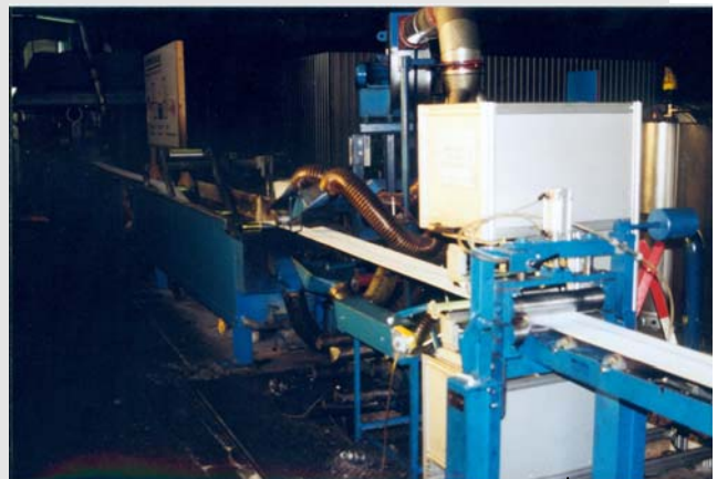
Prüfeinrichtung für Alu-Bänder im Walzwerk
